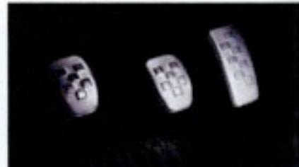
ペダル配置によっても、ヒール&トゥのやりやすさは違ってくる。ペダルカバーなどでアクセルとブレーキの距離や高さを調整してみるといいだろう。
