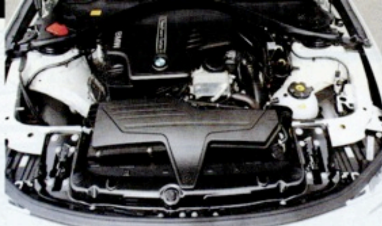
2.0直4ターボエンジンは328と共通だが、320は出力を抑えた仕様になる。
