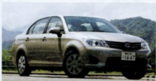
先代比で全長が50mm短くなっているが、すべてがフロントオーバーハングの短縮にあてられた。
