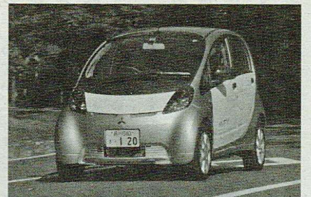
▲i-MiEVに追加設定された「M」は、電池を減らして一充電走行距離を120km（JC08モード）と短くすることで、実質188万円という価格を実現。ただし、その分限定的な使い方だということを肝に銘じておきたい
