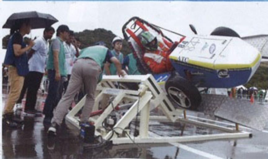
大会は大きく分けて「静的審査」と「動的審査」があり、合計1000ポイントに至る減点法で評価される。前者はコスト/プレゼン/デザインに計325ポイントを割り、後者はアクセル/ブレーキ/スリット/オートクロス/エンデュランス/効率に計675ポイントが充てられる。もちろん、車両がルールに適合しているかを確認する車検も行われ、写真のように45度の傾斜で燃料やオイル漏れが発生しないかなど、厳しくチェックされる。
